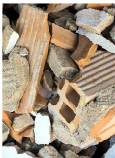
Des gravats récupérés sur un chantier, qui vont être stockés pour ensuite les réemployer - © Gonzalo Ferrer/Freepik
